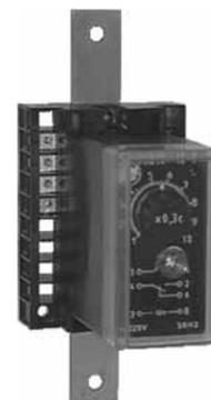
Реле PCB18-Р поставляются с переходной пластиной для установки PCB18 вместо заменяемого реле. Два отверстия с межосевым расстоянием 75 мм служат для крепления реле PCB18 на пластине. Отверстия с межосевым расстоянием Н служат для крепления пластины вместе с реле к рейкам комплектного устройства. При заказе реле PCB18-Р взамен аналогов (кроме PB100, PB200) должны быть указаны размеры переходной пластины Н и L.
