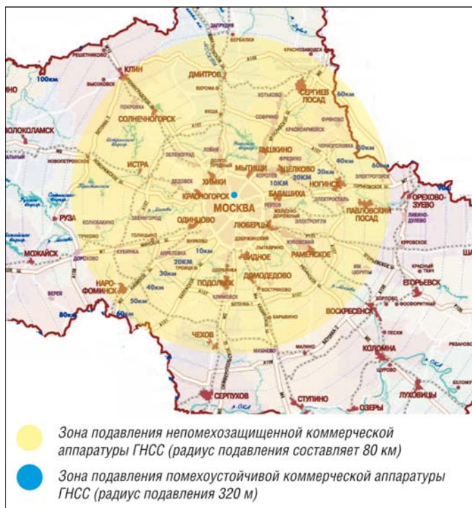
Зоны подавления навигационной аппаратуры: типовой коммерческой и аппаратуры с помехоустойчивостью вышена 50 дБ
